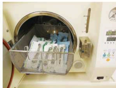
⑤ 高圧蒸気滅菌器による滅菌
